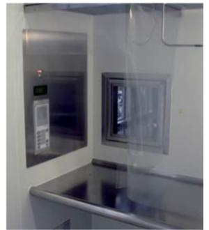
Laminar Flow-Arbeitsplatz mit Materialschleuse
